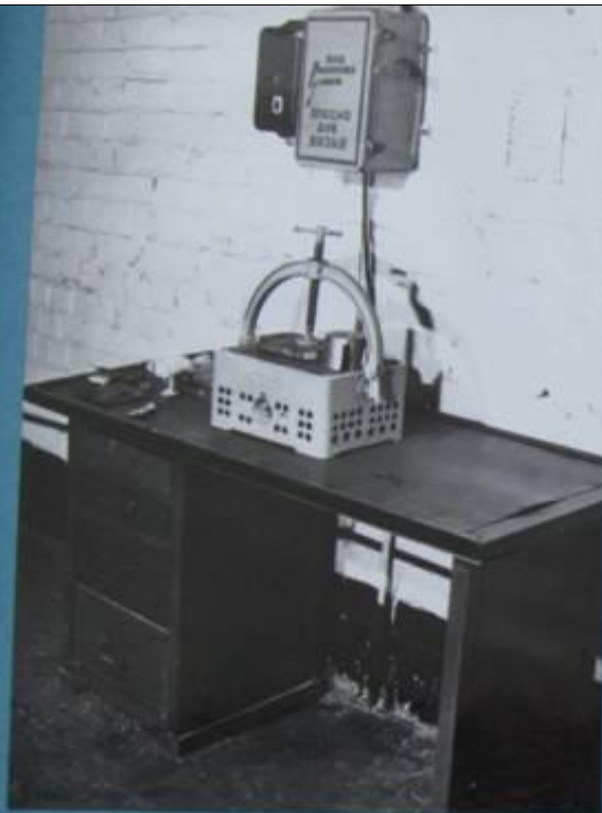
Пост вулканизационных работ и ремонта автомобильных камер
